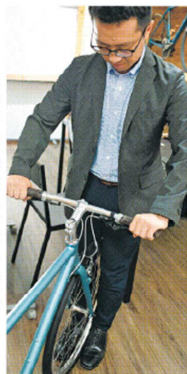
両足で前輪を挟み、手でハンドルを動かしてみてもかたつきがないか確認する
